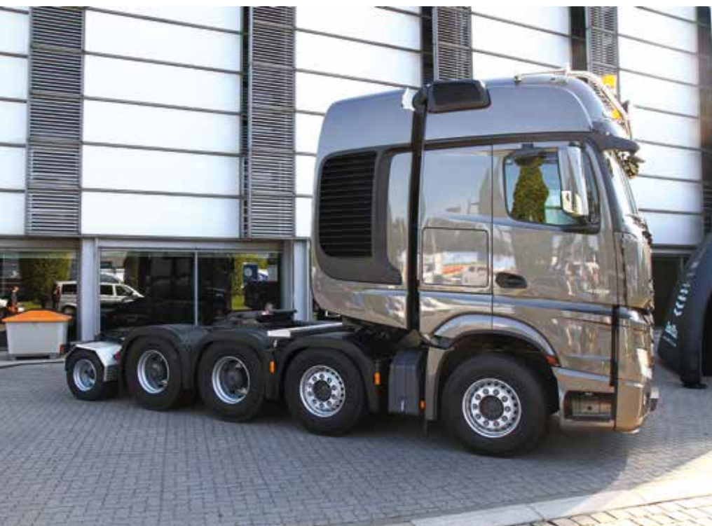
Fünfachsiger Actros durch eine von Titan gefertigte modulare Koppelachse.
