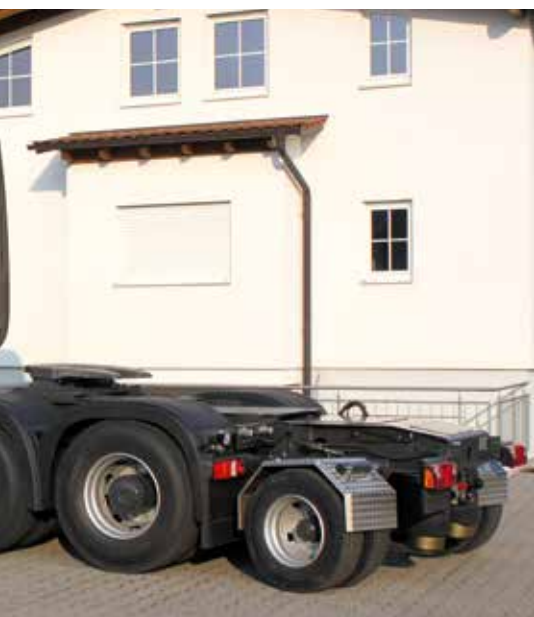
Diese modulare, koppelbare Achse fertigt Titan, um damit aus einem vier- einen fünfsachsigen Actros zu erstellen.
