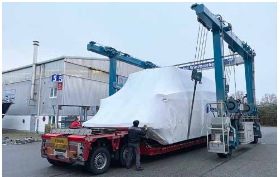
In der norditalienischen Bootswerft Absolute S.p.A. wird die 19 Tonnen schwere Motoryacht auf den zweiachsigen Pendelachsflachbett-Trailer Euro 49 PX des niederländischen Herstellers Nooteboom Trailers B.V. verladen.
