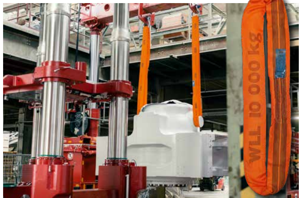
Die Rundschlinge von SHZ zum schonenden Heben und Senken im Einsatz.
