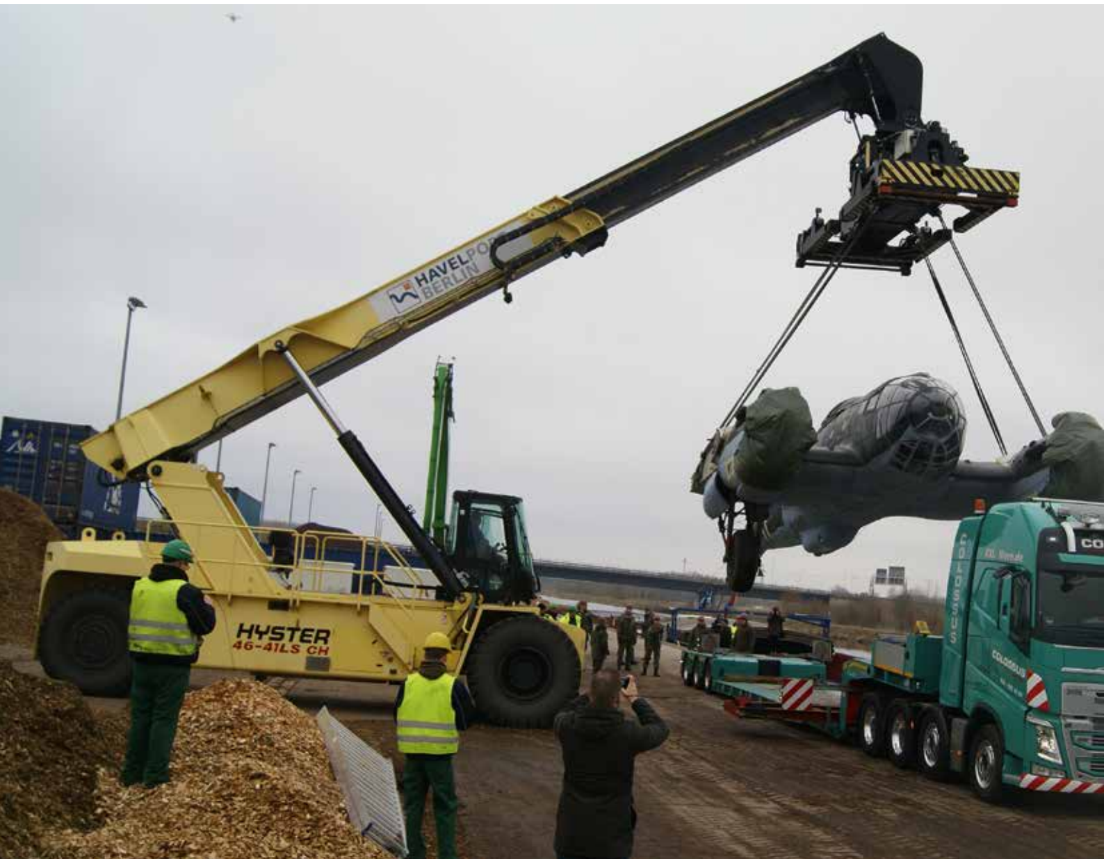
Per telekopierbaren Container-Stapler wechselt der Flugzeugrumpf vom Tieflader ...
