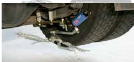
Die Schleuderkette „ ROTOGRIP “ von RUD ist hierzulande nur als Anfahrhilfe zugelassen.
