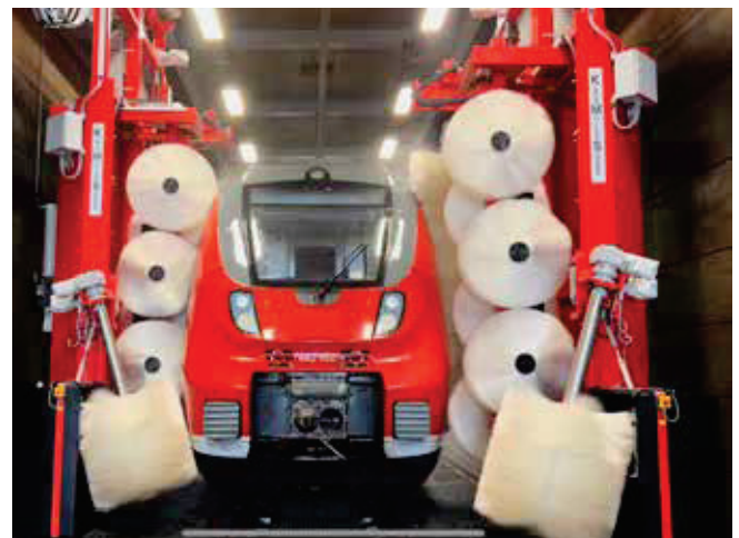
Die KMS 79 ist vorrangig für den Schienenverkehr konzipiert, kann aber auch für die Nutzfahrzeugwäsche verwendet werden.
