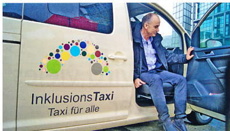
Martin Maubach, wissenschaftlicher Mitarbeiter beim Sozialverband Deutschland, demonstriert den herauschwenkbaren Beifahrersitz, der bei Rollstuhltaxis noch selten ist.
