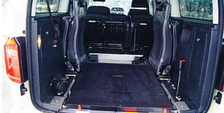
Ohne Rollstuhlnutzer verschwindet die Rampe im Fahrzeugheck und ermöglicht eine glatte Ladefläche sowie das Ausklappen der Rücksitze.
